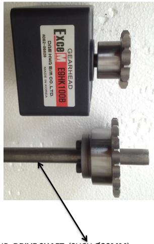
NOTE: USE RIGHT TAPPER LOCK DIAMETER RESPECTED TO YOUR DRIVE SHAFT (SUCH Ø20MM)
